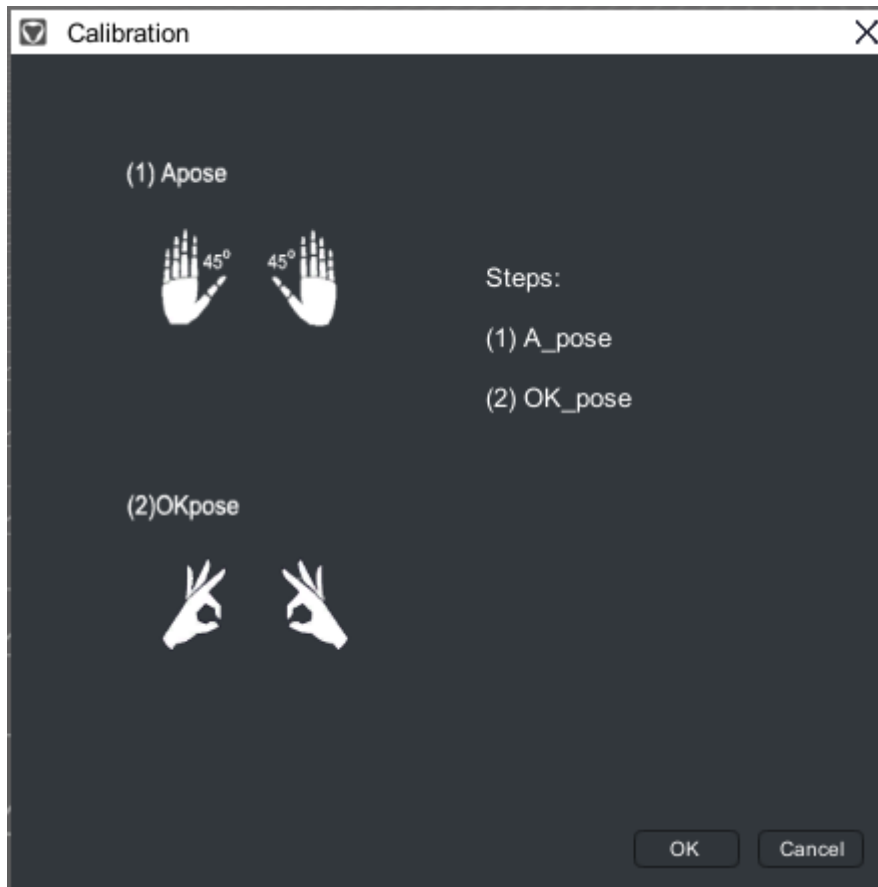
图 1 mHand 动捕设备 A_pose 及 OK_pose 标定。所述 A_pose：双手放平，掌心向下，除大拇指外四指平行并拢，大拇指与食指夹角 45 度。所述 OK_pose：大拇指指尖与食指指尖接触形成一个圆圈，其它手指伸直。
